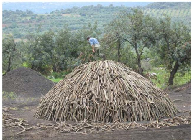
Der Grundaufbau eines Meilers erfordert "vieler Hände Arbeit" und Kraftaufwand (Abb. links); der Stangenverbau (vor dem abschließenden "Dach") ist dagegen eher eine Arbeit für "Spezialisten mit Erfahrung" (Abb. rechts).
